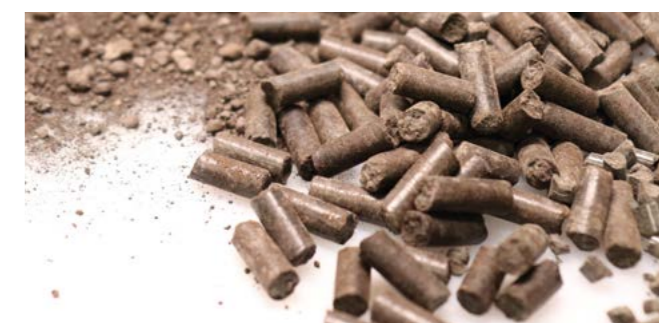
↑ Granulés de boues STEP
