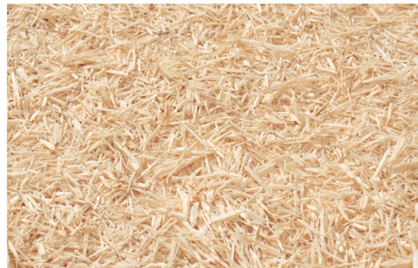
↑ Plaquettes de bois à la sortie du broyeur à marteaux
