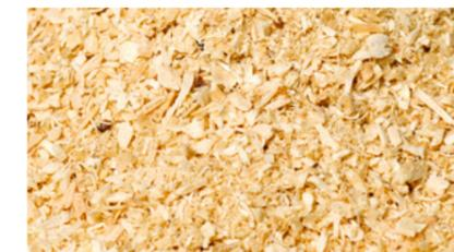
↑ Bois de pin à la sortie du broyeur à marteaux
