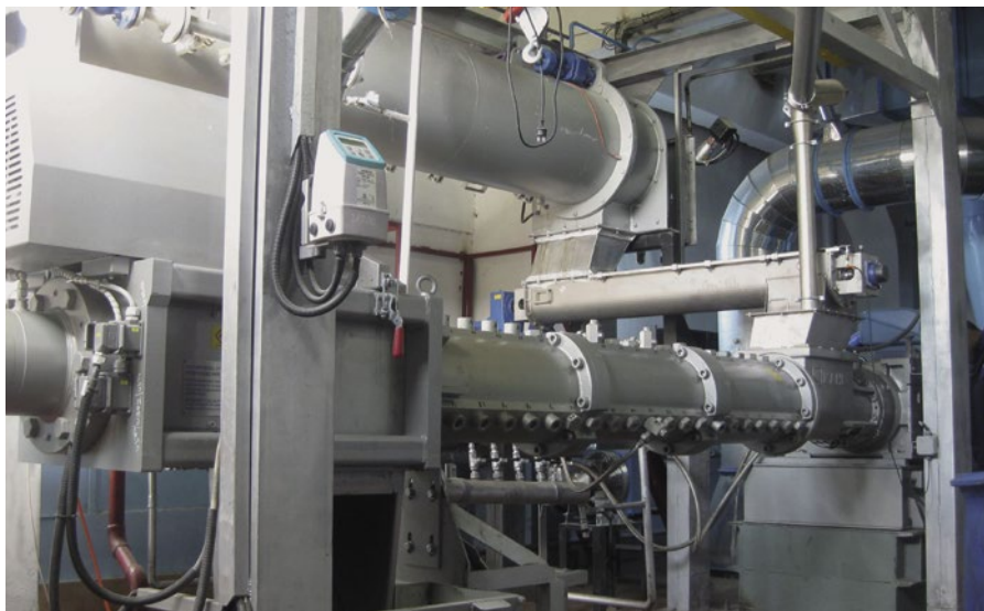
Кондиционер и экструдер на линии по производству корма для рыб
